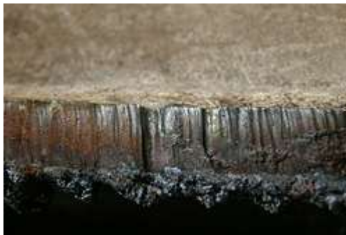
Slobodni rez od debele čelične ploče
